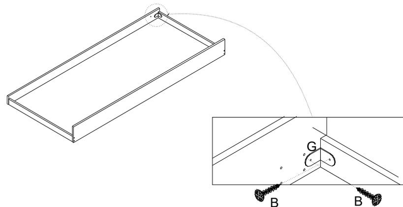
**1º passo**- Fixar suporte p/ lastro (D) na frente/traseira da (02 e 03) com parafuso 4x14 cabeça flange(B)
